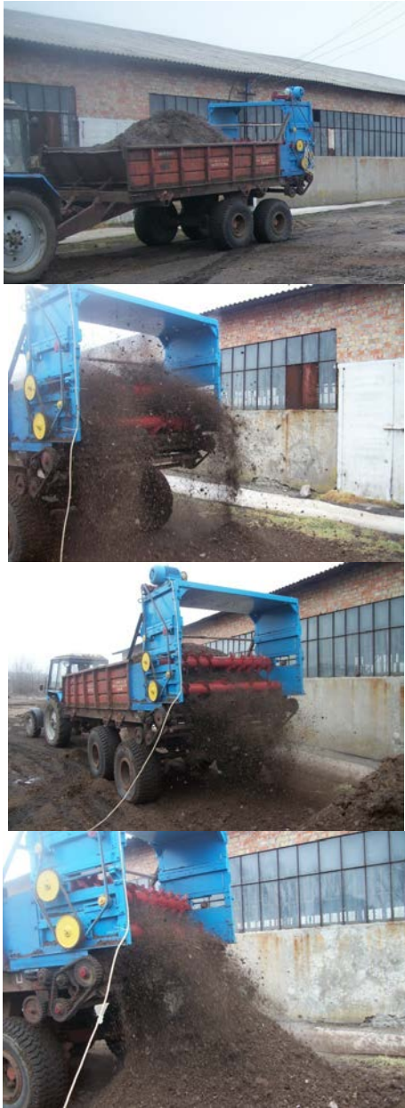
Рис. 3. Процес механічної аерації і змішування гное-компостної суміші на експериментальній установці на базі причіпного розкидача добрив ПРТ-10 із двобарабанним навісним пристроєм.
