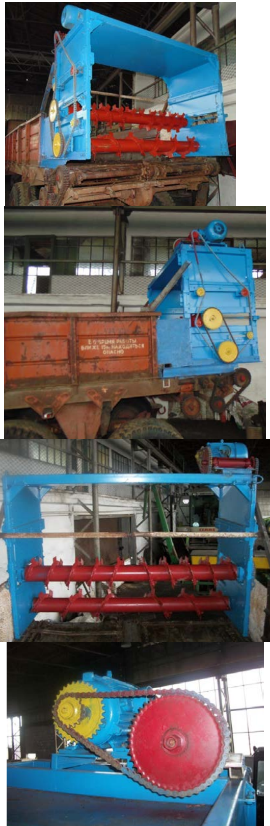
Рис. 1. Загальний вигляд експериментальної установки на базі причіпного розкидача добрив ПРТ-10 із двобарабаним навісним пристроєм для подрібнення твердих органічних добрив.
