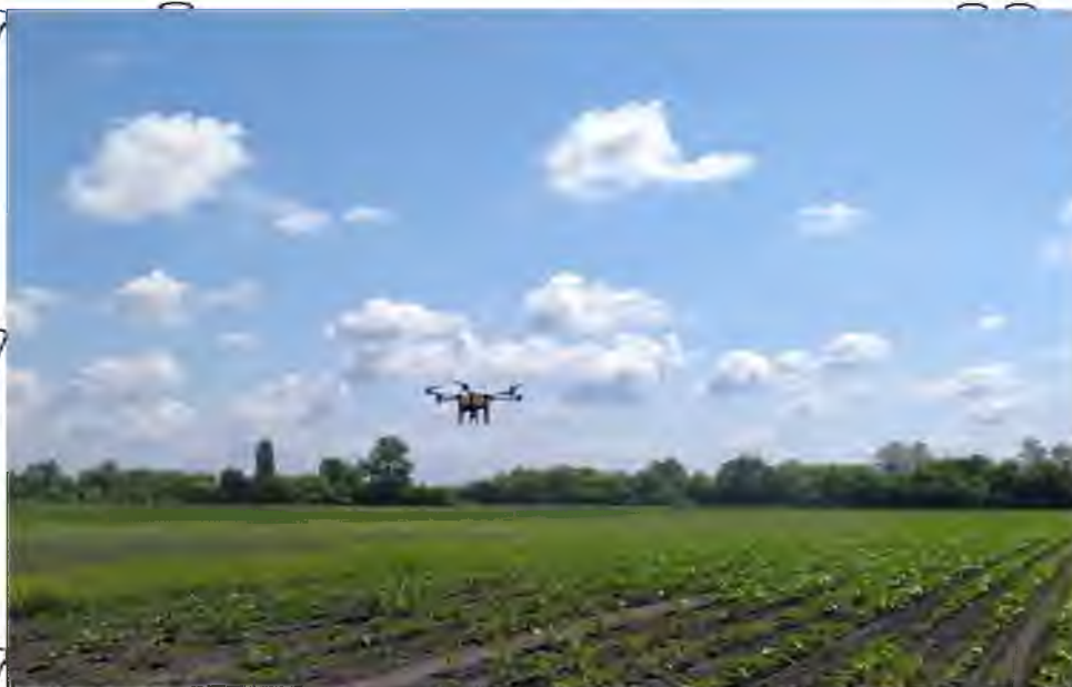
Рис. 6.1 Внесення біопрепаратів за допомогою безпілотних технологій на посівах соняшнику
