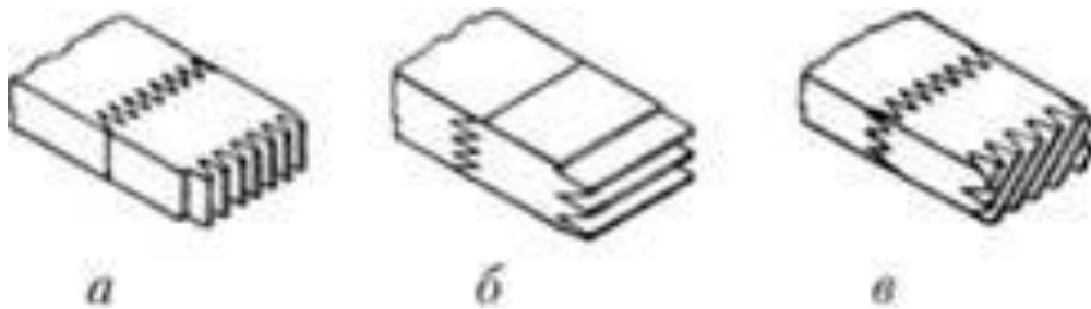
Рис.1. Зубчасті клейові з'єднання: а - вертикальне; б - горизонтальне; в – діагональне
