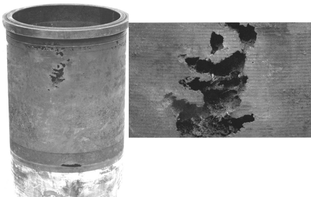
Рис. 1. Гільза циліндра з кавітаційними uszkodженнями. Зйомка крупним планом гільзи циліндра з гострими краями і отворами, що розширюються всередину.
