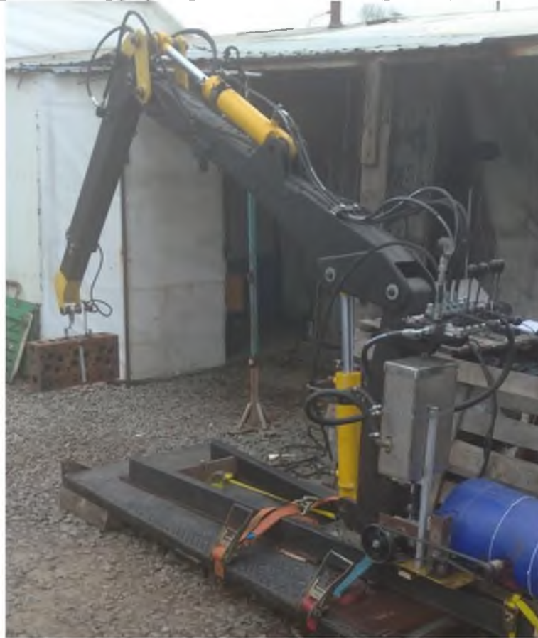
Рис. 1. Експериментальна установка крана-маніпулятора з гідравлічним приводом
