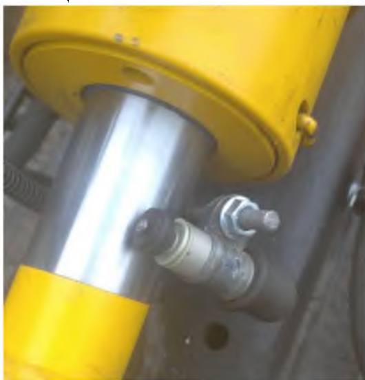
Рис. 4 Розміщення датчиків лінійного переміщення: а) датчик лінійного переміщення штоку гідравлічного циліндра приводу рукояті; б) датчик лінійного переміщення телескопічної секції
