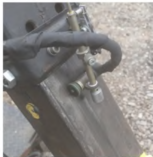
Рис. 4 Розміщення датчиків лінійного переміщення: а) датчик лінійного переміщення штоку гідравлічного циліндра приводу рукояті; б) датчик лінійного переміщення телескопічної секції
