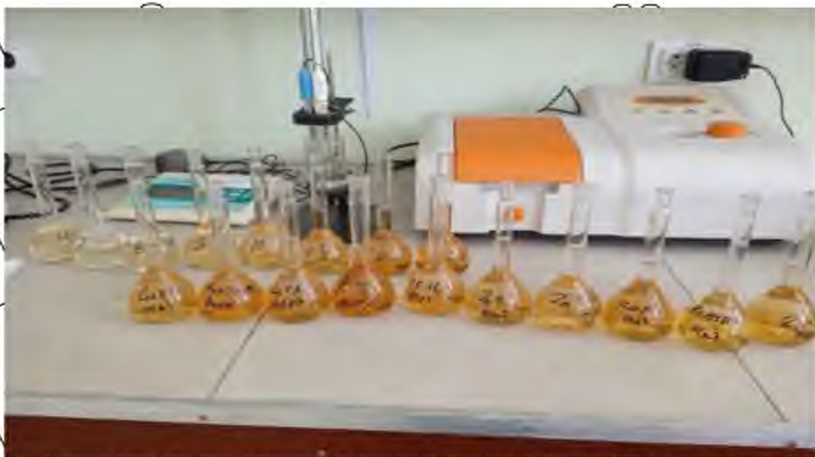
Рисунок 2.4.5. Підготовка розчинів до фотометричного визначення вмісту азоту в рослинах із реактивом Несслера
