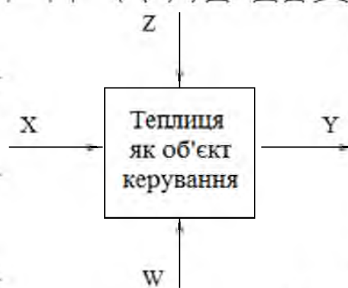
Рис. 2.1. Модель теплиці як об'єкта автоматичного керування:
