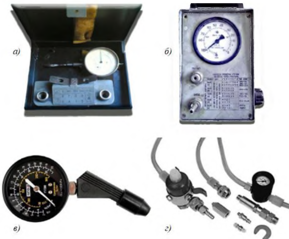
Рис. 1. Засоби діагностування ЦПГ ДВС: а – газовий витратомір ГОСНИТИ; б – К-69М; в – компресиметр; г – пневмотестер К-272.
