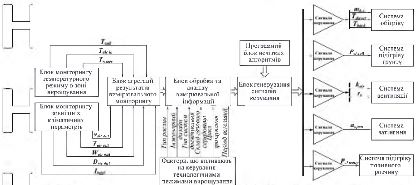
Рис. 2.15 Уточнена функціональна схема процедури моніторингу параметрів температурного режиму вирощування
