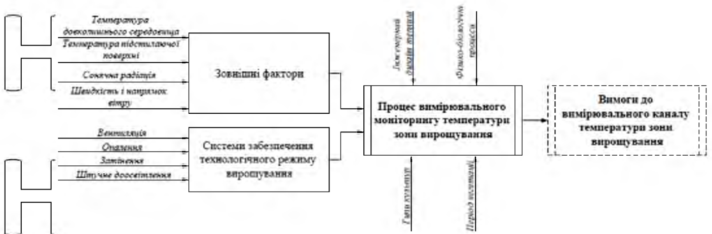
Рис. 2.1. Структурна схема моніторингу температури зони вирощування
