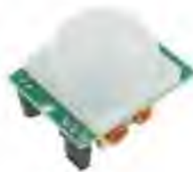
Рисунок 4.5– ІЧ датчик HC – SR501
