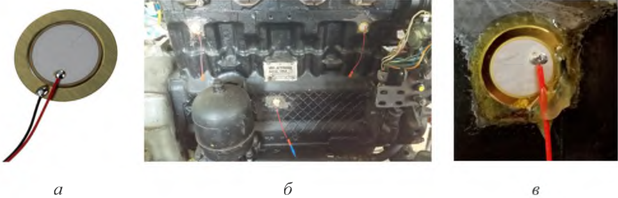
Рис. 1. Загальний вигляд п'єзовипромінювача 27 мм без корпусу і без генератора (а), фото місце монтажу на дизелі моделі 4С12/14 (б) і загальний вигляд наклеєного з допомогою термостійкого двокомпонентного клею на епоксидній основі (в)
