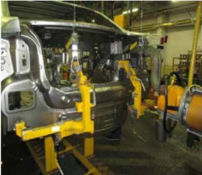
Рис. 20 Пристрій для монтажу «Спідниця задня» на кузов
