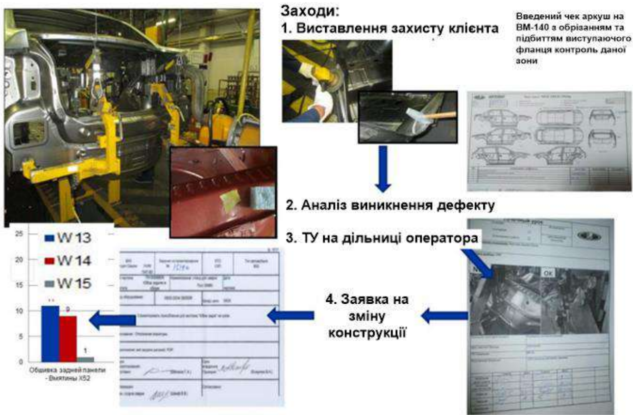
Рис.33 Приклад відпрацювання дефекту майстром
