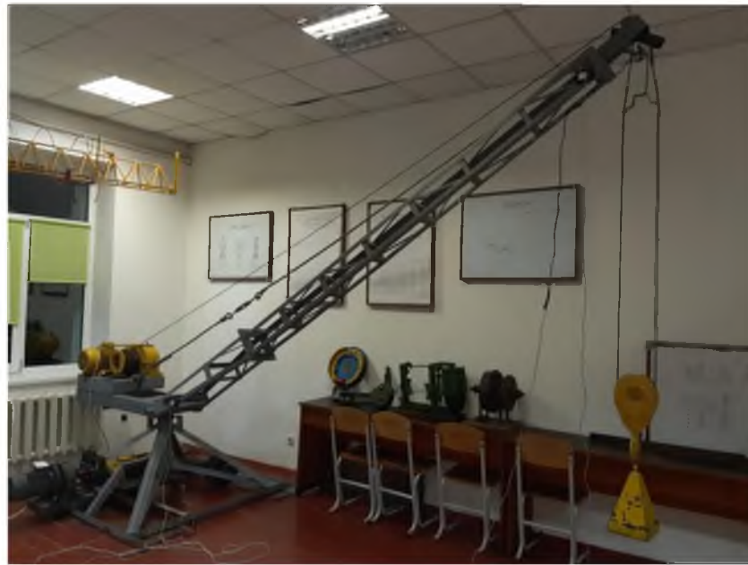
Рис. 2. Загальний вигляд лабораторної установки для дослідження динаміки руху механізму повороту стрілового (баштового) крана з закріпленими датчиками
