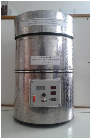
Рис. 7. Установка для стимуляції насіння тепличних культур комбінованим оптичним опромінюванням
