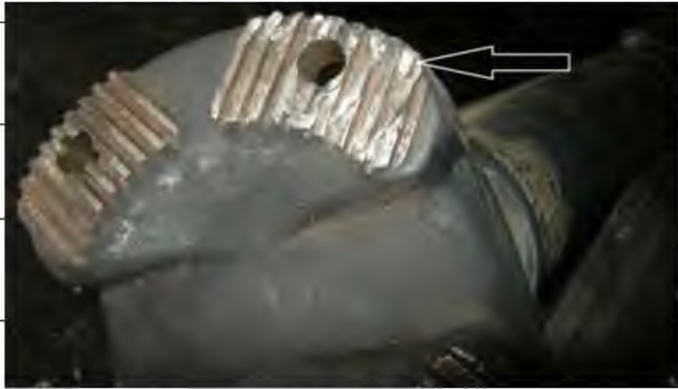
Рис. 3.6. Знос кріплення кордного валу
