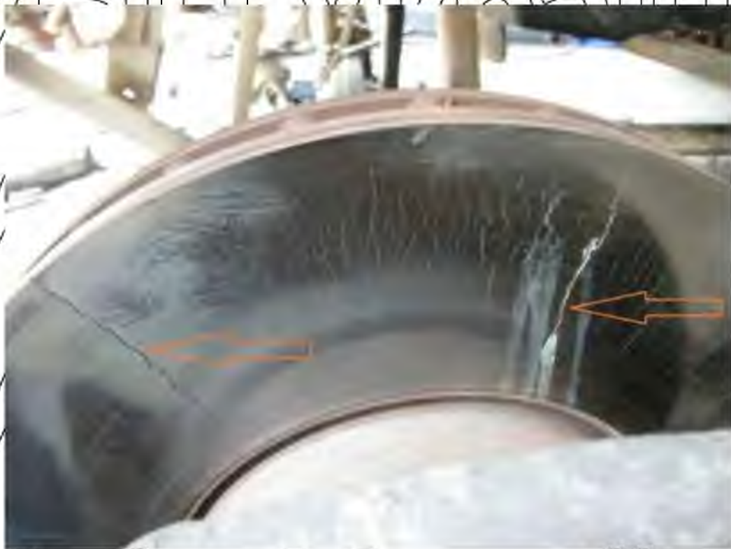
Рис. 3.9. Тріщина на гальмівному диску
