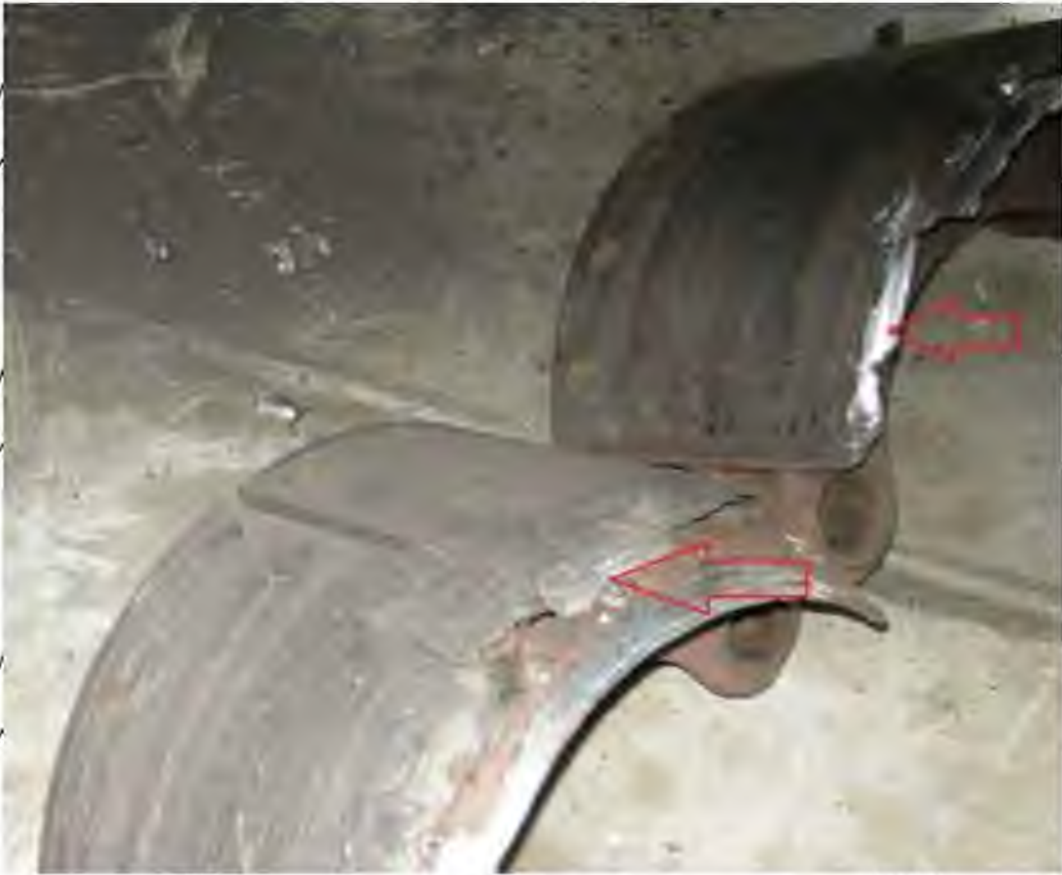
Рис. 3.8. Пошкодження гальмівних колодок
