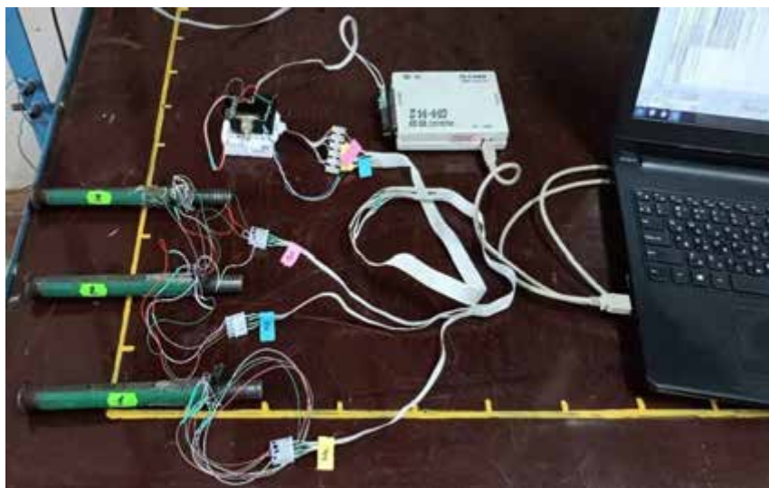
Рис. 2. Вигляд електричного вимірювального обладнання для визначення сили удару кореневищ міскантусу по пальцях надбарабання
