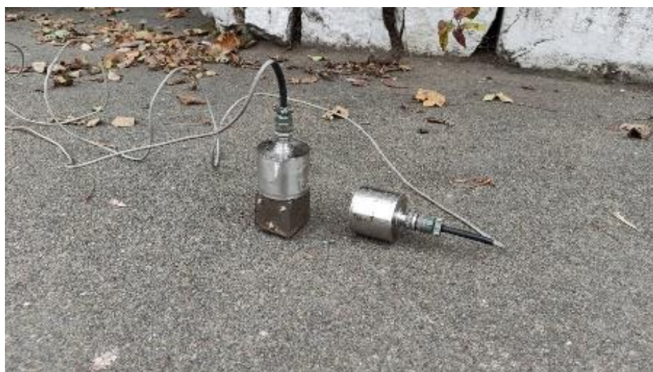
Рис. 2. Розміщення датчиків вібрації на ґрунті
