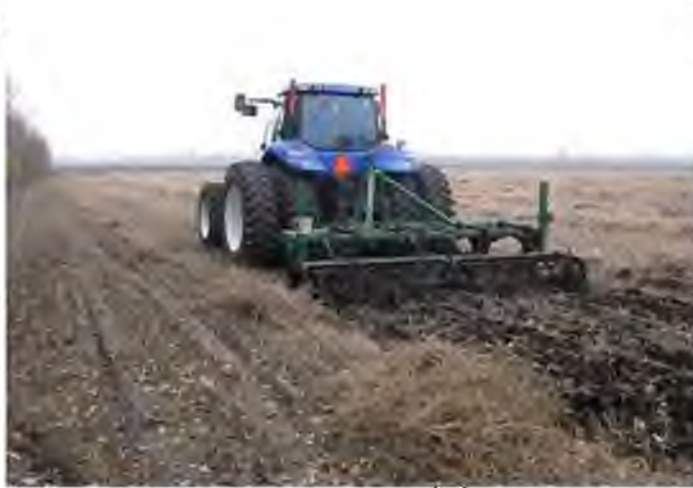
Рис. 1.3 Безполицевий обробіток ґрунту чизельним знаряддям
