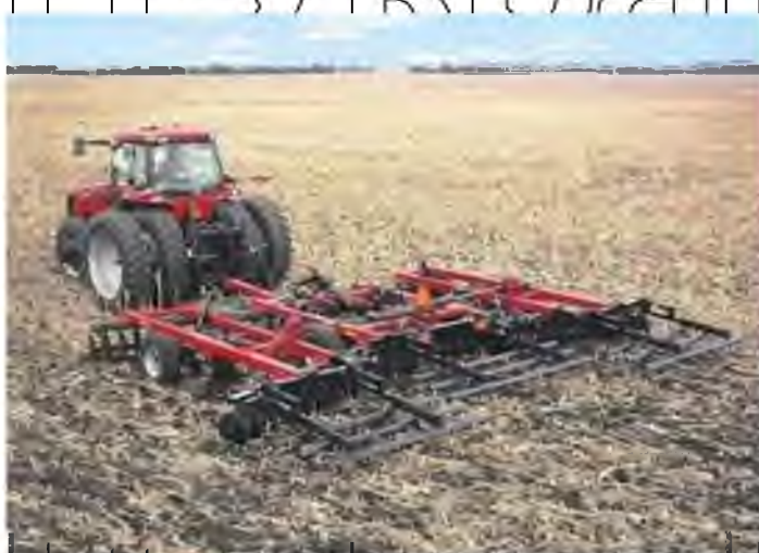
Рис. 1.2 Виконання ґрунтозахисного обробітку комбінованим агрегатом
