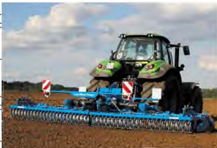
Рис. 1.4 Ротаційна борона Zirkon від LEMKEN на обробітку ґрунту
