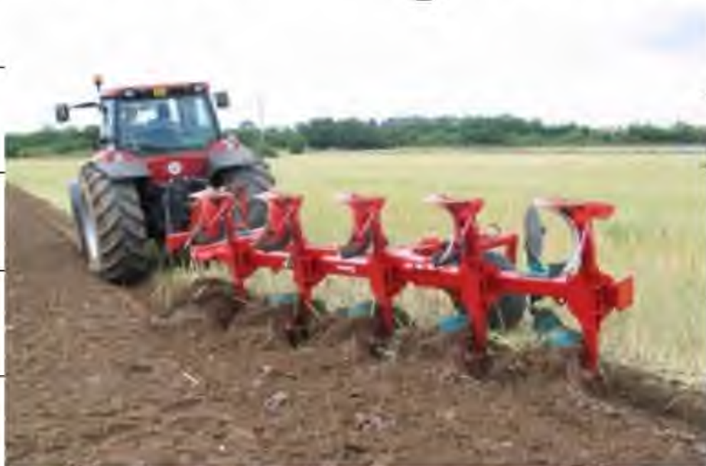
Рис. 1.1 Виконання глибокої оранки п'ятикорпусним обероним плугом. По способу агрегування усі плуги діляться на начіпні, причіпні та напівначіпні.
