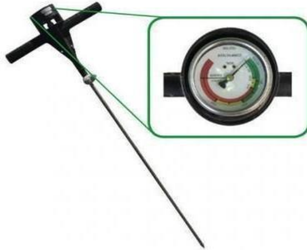
Рис. 1 – Загальний вигляд ручного пенетрометра з механічною шкалою
