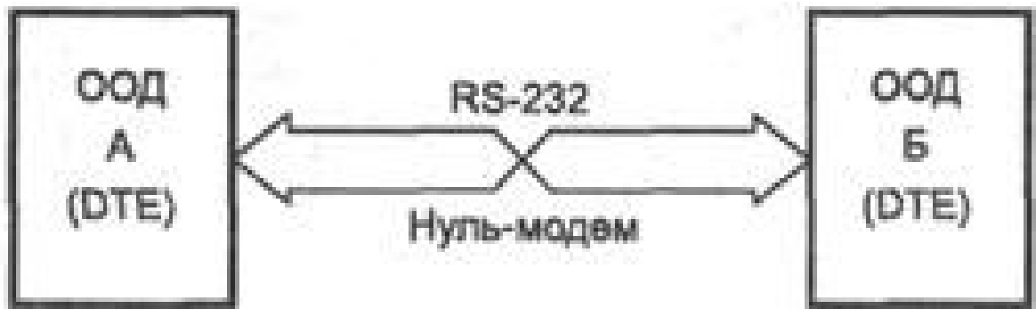
Рис. 4.49. Підключення через нуль-модемний кабель RC-232
