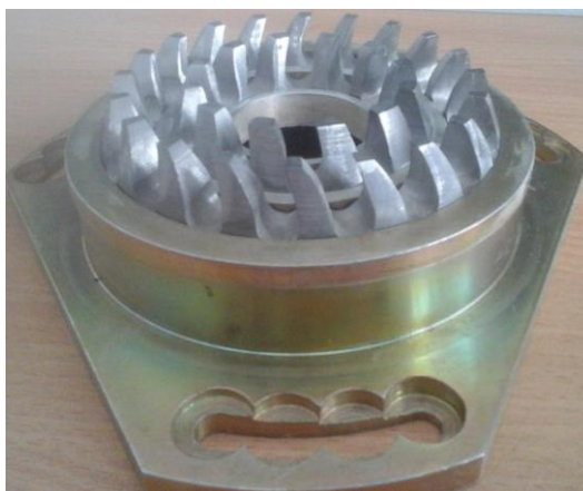
Рис. 3.2 Експериментальні робочі органи подрібнювача зернових матеріалів
