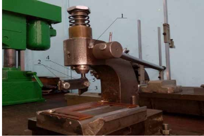
Рис. 3.7. Пристрій для визначення кута різання: 1 – ручний прес, 2 – затискні гвинти, 3 – змінне лезо, 4 – хвостовик, 5 – корпус пристрою
