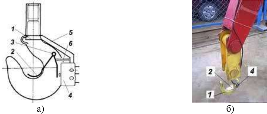
Рис. 3.3 – Датчик наявності вантажу на гаку: а) схема датчика наявності вантажу на гаку, б) зовнішній вигляд підвіски з датчиком наявності вантажу.
