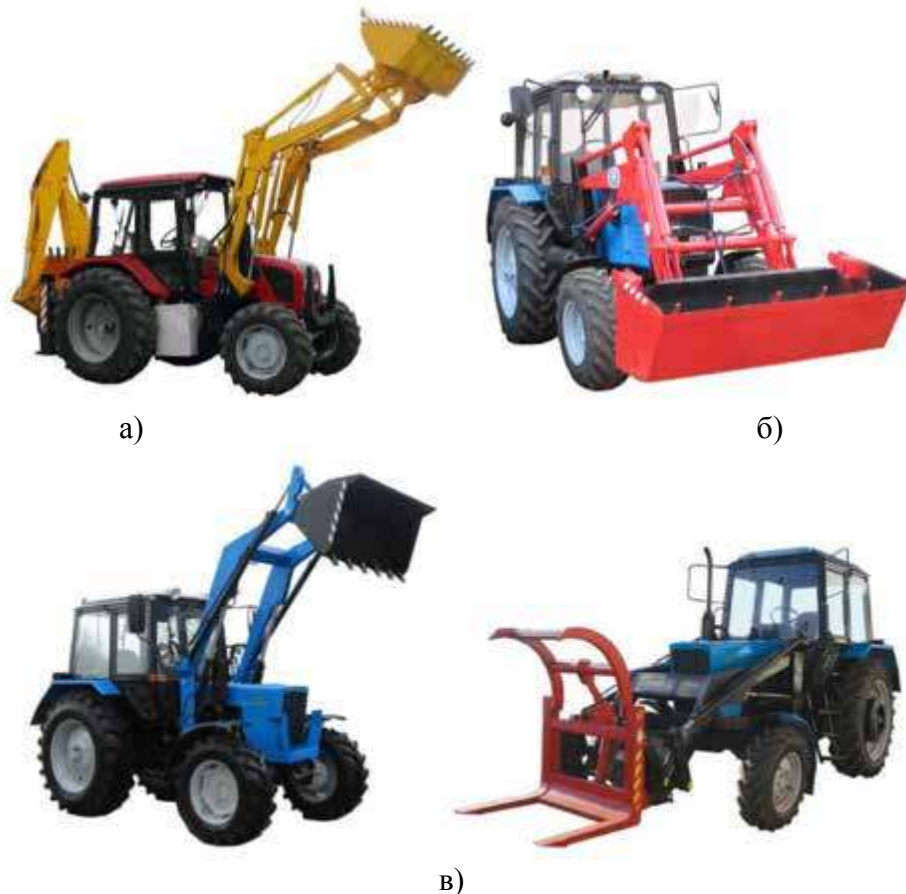
Рис. 1.5 – Фронтальні навантажувачі: а) екскаватор-навантажувач «БЕЛАРУС» ЕП-491; б) фронтальний навантажувач ПФН-0.9 «Піонер»; в) навантажувач фронтальний сільськогосподарський ПФС-0,75.
