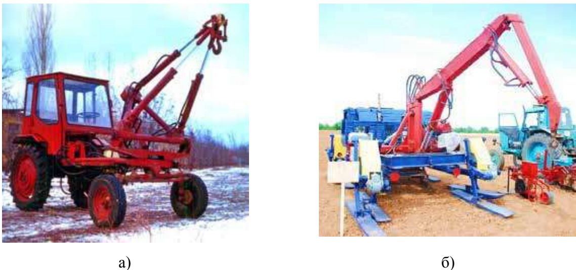
Рис. 1.4 – Навантажувальні маніпулятори: а) безстрільовий навантажувальний маніпулятор БПМ-0,5; б) навісний маніпулятор НМВ-1,5.
