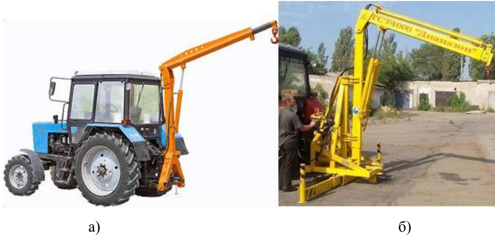
Рис. 1.3 – Навантажувачі та маніпулятори для вантажопереробки контейнерів і пакетованих вантажів: а) МГН-1200; б) ГСТ -1000 «Діапазон».
