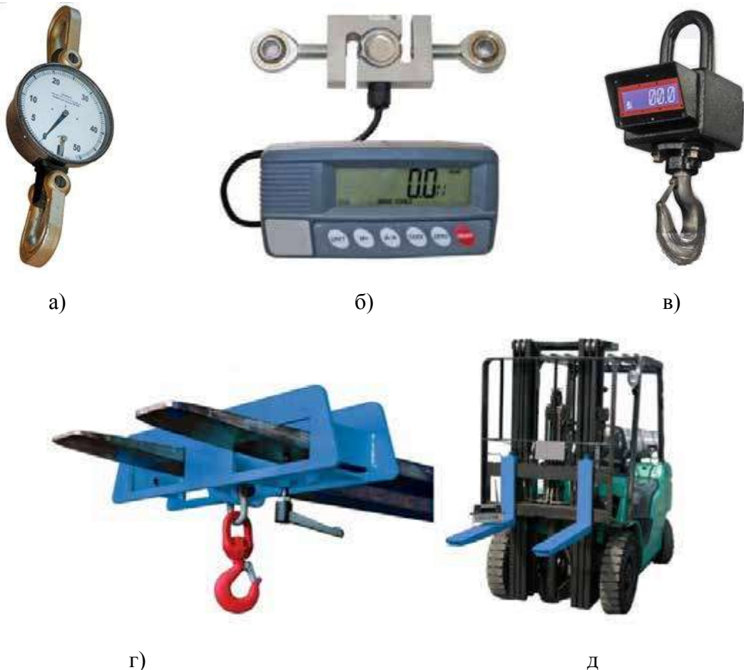
Рис. 1.11 – Варіанти вимірювання ваги для навантажувачів і кранів-маніпуляторів різного призначення: а) механічний динамометр; б) електронний динамометр; в) кранові ваги (для підвіски крюка); г) кранові ваги для вил; д) вила навантажувача з вбудованими вагами
