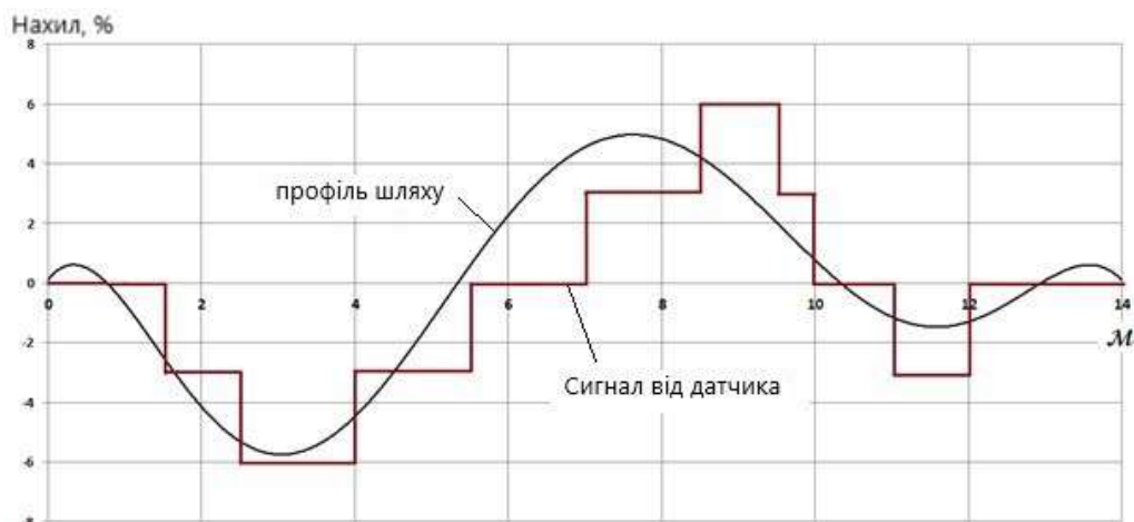
Рис. 3.20 – Динаміка реагування датчика при русі навантажувача по нерівностях
