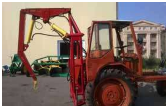
Рис. 3.4 – Зовнішній вигляд навантажувального агрегату на базі СШ Т-16МГ і навісного маніпулятора НПМ-0,6
