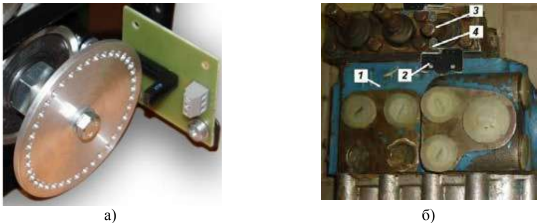
Рис. 3.2 – Датчики: а) датчик руху бар'єрного типу (оптичний енкодер); б) розміщення датчиків включення гідроприводу; 1 – гідророзподільник, 2 – мікроперемикач МП, 3 – важіль управління золотником, 4 – пружинна кнопка мікроперемикача.
