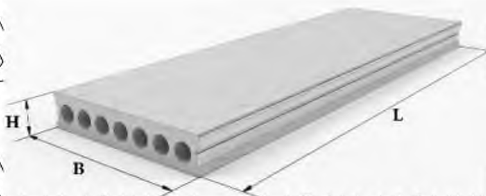
Рис. 3.1. Фактичні габаритні розміри плити ПК60-15: L=5980\text{мм} ;
