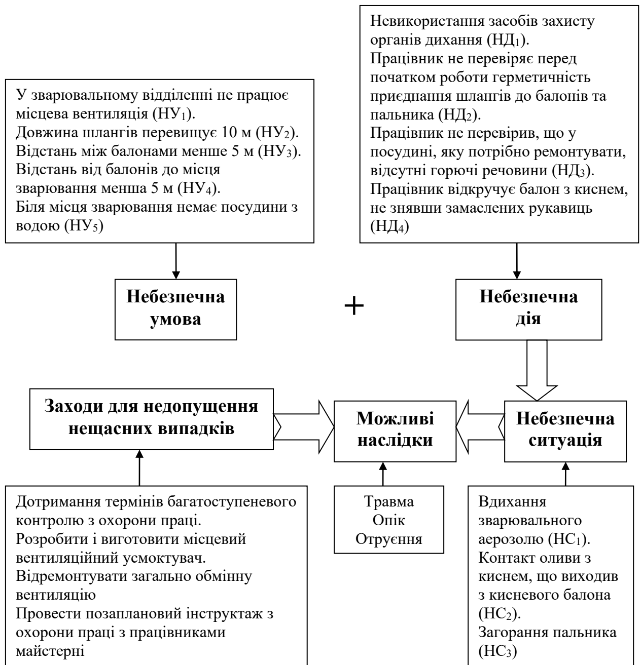
Рис. 3.3. Умови створення небезпечних ситуацій на робочому місці газозварювальника
