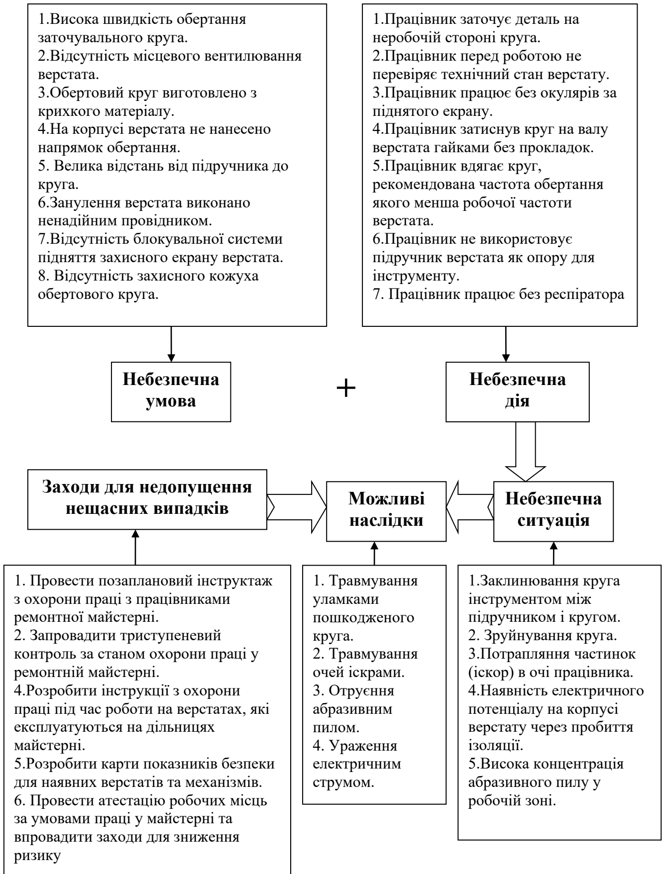
Рис. 3.4. Аналіз небезпек під час роботи на заточувальному верстаті
