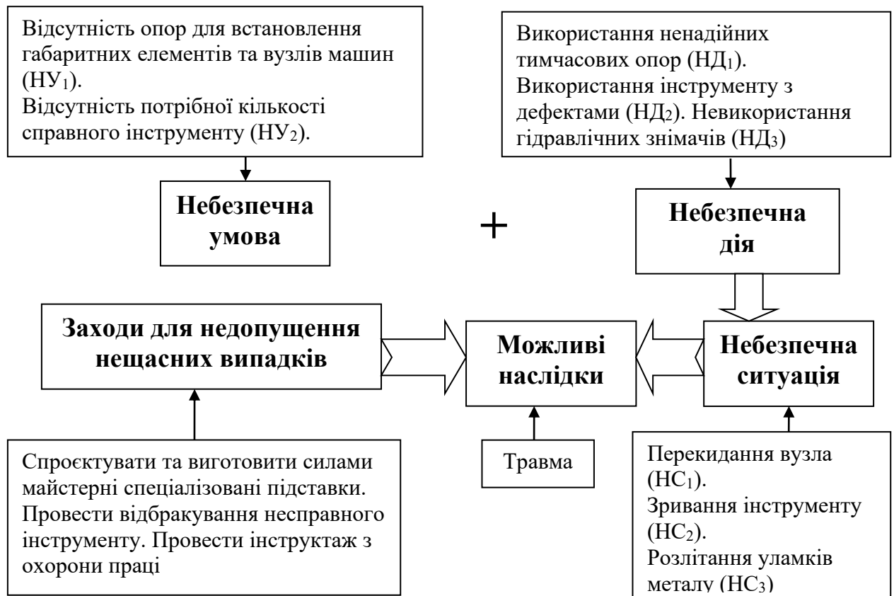
Рис. 3.1. Умови створення небезпечних ситуацій під час розбирально-складальних робіт на сільськогосподарській техніці
