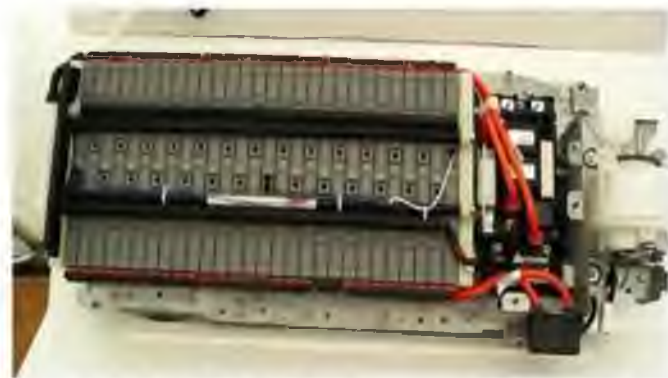
Рис. 1.15 – Акумуляторні батареї гібридного автомобіля
