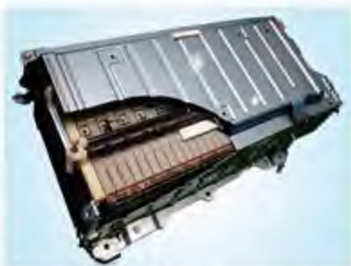
Рис. 1.15 – Акумуляторні батареї гібридного автомобіля
