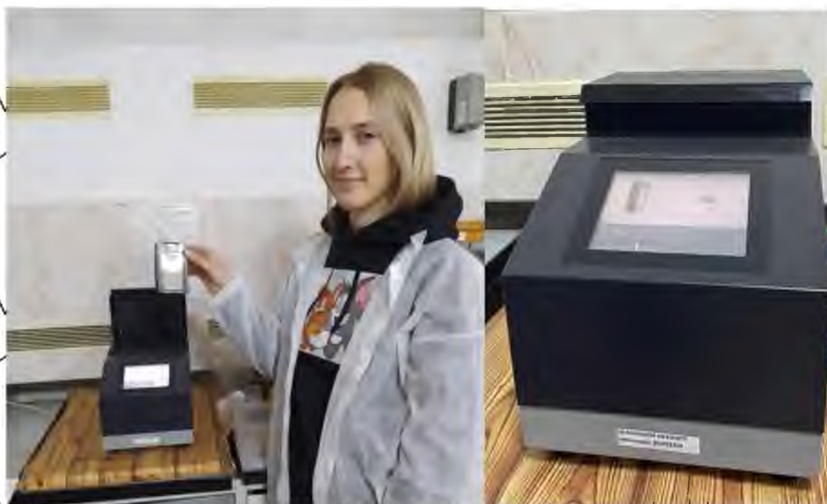
Рисунок 2.7. Визначення вмісту білка на приладі AN-920 KETT
