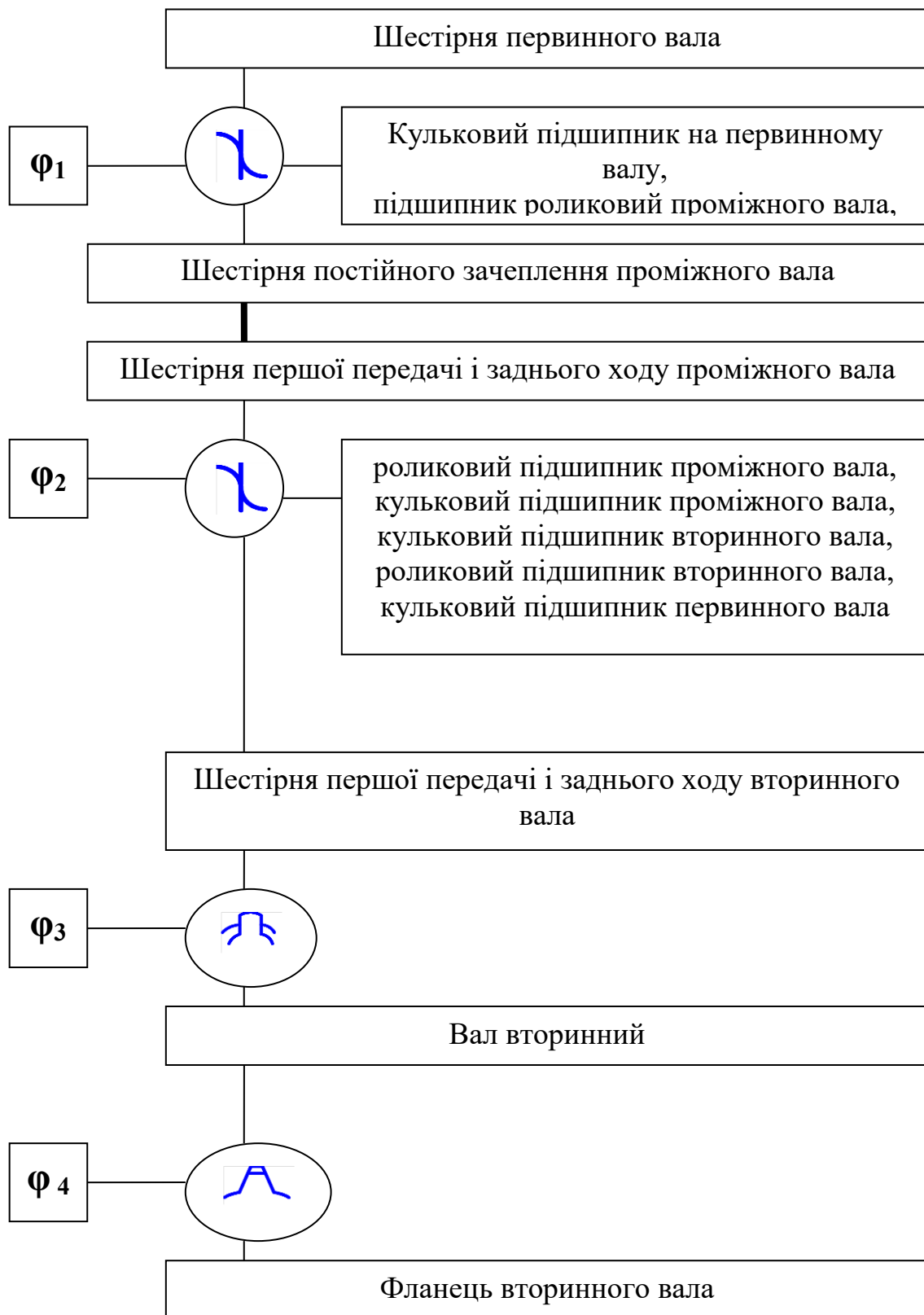
Рис.2.6 Структурна модель контактів деталей при ввімкненні першої передачі, яка показує типи контактів, де виникає зазор, та перелік деталей, технічний стан яких опосередковано впливає на кутовий люфт. \Phi
