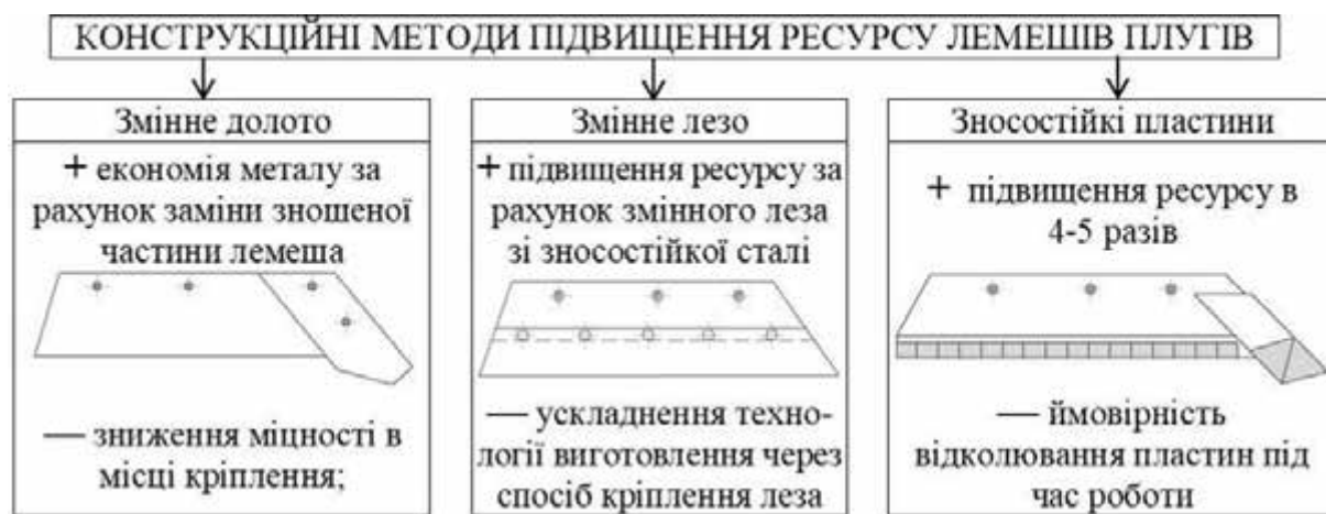
Рис. Конструкційні методи підвищення ресурсу лемешів плугів
