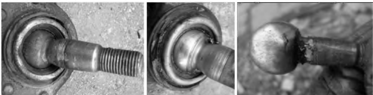
Рис. 2. Знос кульового пальця в перерізі переходу сферичної частини в конічну
