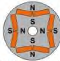
Рисунок 1.15 – Ротор синхронного двигуна із вбудованими магнітами
