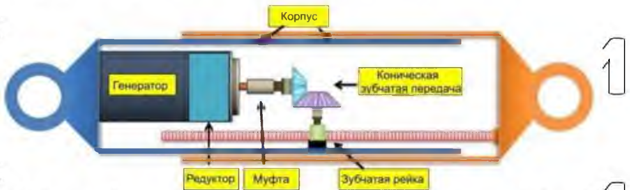
Малюнок 1.9 Конструкція регенеративного амортизатора з механізмом приводу, що складається з рейкової та конічної передачі
