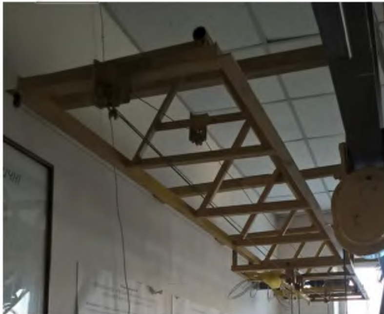
Рис. 1. Загальний вигляд конструкції фізичної моделі стрілової системи баштового крана.
