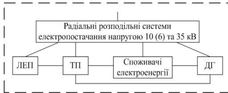
Рис. 1. Функціональна блок-схема системи електропостачання територіально розподіленого навантаження: ЛЕП – лінії електропередавання; ТП – трансформаторні підстанції; ДГ – джерела генерації
