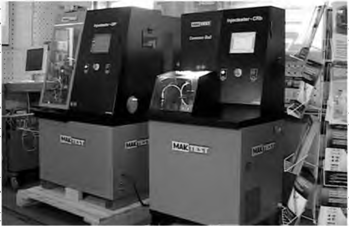
Рис. 1.16 - Загальний вигляд стану MAK TEST для перевірки та ремонту форсунок
