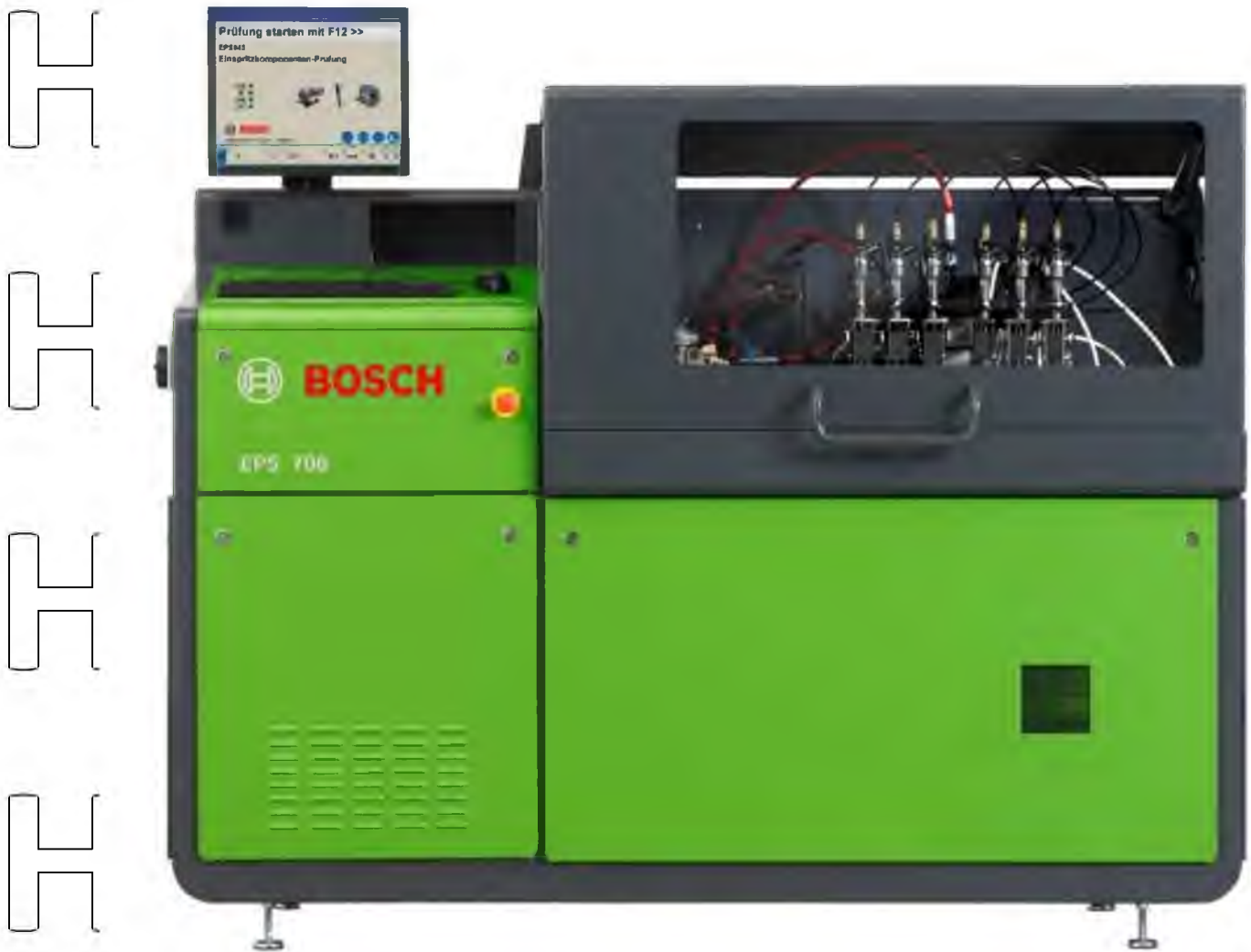
Рис. 1.15 - Стенд Bosch EPS 708 для перевірки компонентів паливної системи Common Rail.
