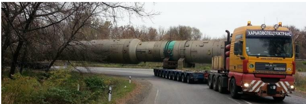
Рис. 1. Розсувна платформа для транспортування понад негабаритних вантажів
