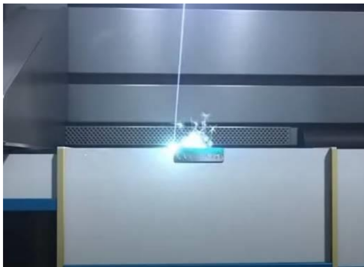
Рис. 1. Спікання лазером шару металевого порошку
