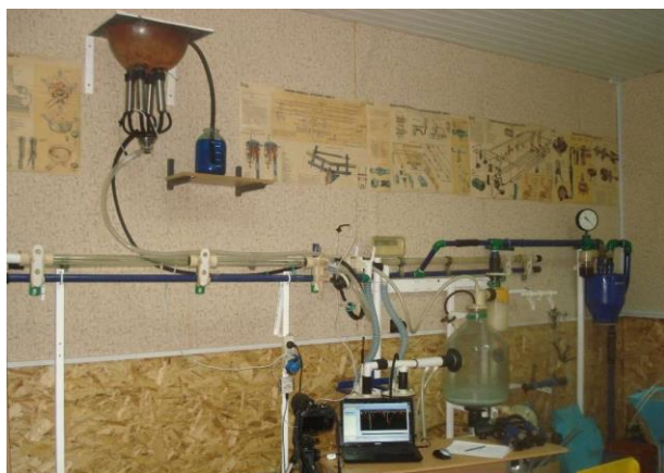
Рис. 3. Загальний вид експериментального стенду доїльної установки із доїльним апаратом одночасної дії при підключенні його до нижнього молокопроводу
