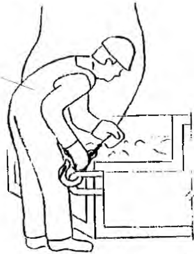
Рис.3.6 Стропекування петлі бункера повгооротного за підйомн
