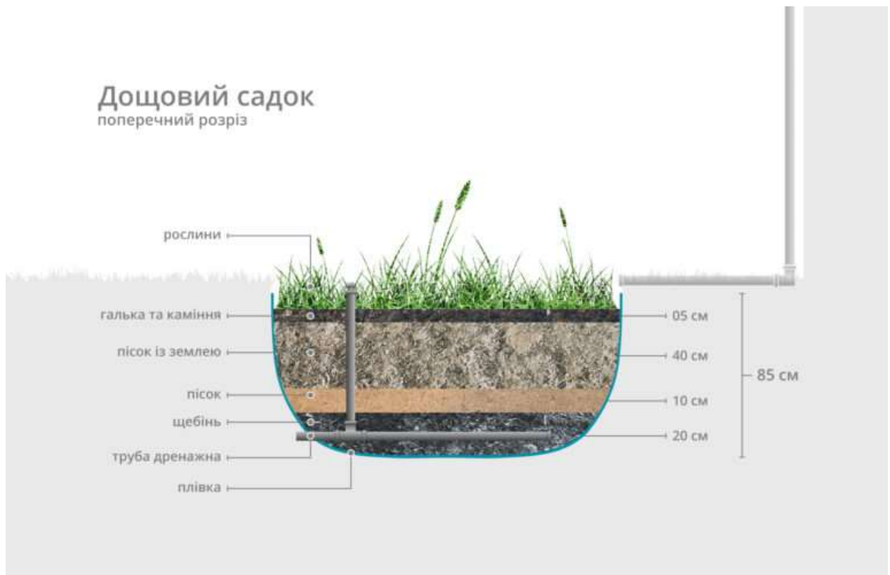
Рис. 4.11. Поперечний розріз дощового саду [34]
