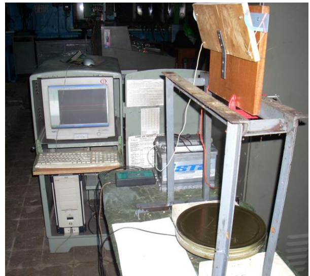
Рис. 8. Схема установки для визначення часу падіння зернини: 1 – штатив; 2 – насінина; 3 – контакт; 4, 5 – нерухома та рухома поверхні клапана; 6 – джерело струму; 7 – USB-осцилограф; 8 – ПЕОМ; 9 – площадка; 10 – вібрдатчик.
