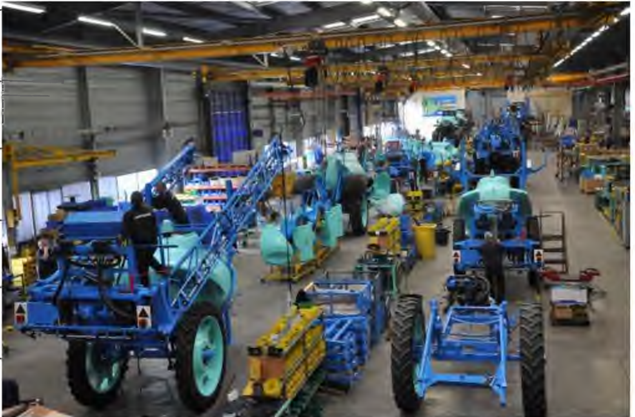
Рисунок 7 - Лінія складання причіпних обприскувачів
