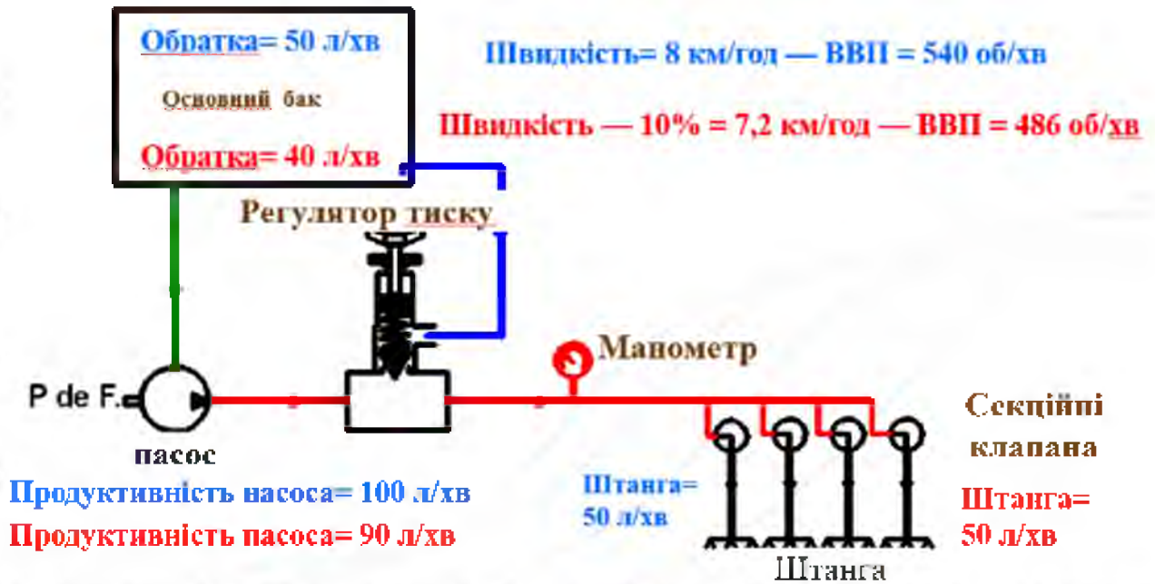
Рисунок 14 – Конструктивно – технологічна схема системи з постійним тиском
