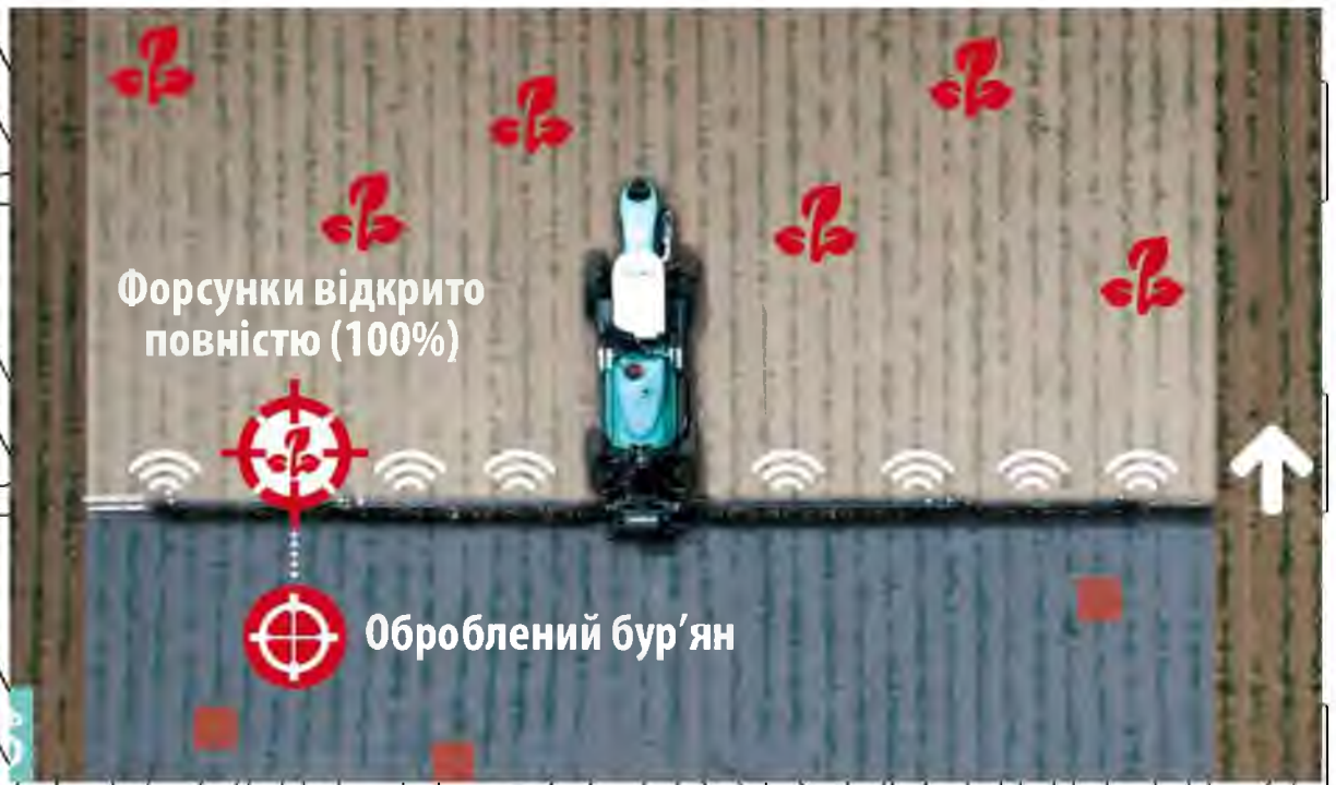
Рисунок 27 - Режим "DUAL-RATE" системи ультралокалізованого (точкового) обприскування SNIPER
