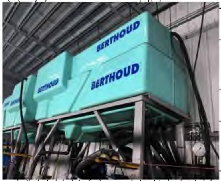
Рисунок 55 – стенд для обкатки насосів на заводі Berthoud (Франція м. Бельвіль)
