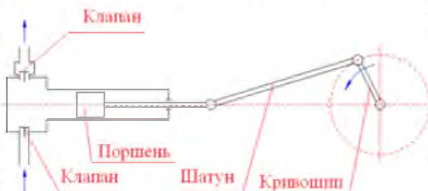
Рисунок 41 – конструктивна схема поршневого насоса
