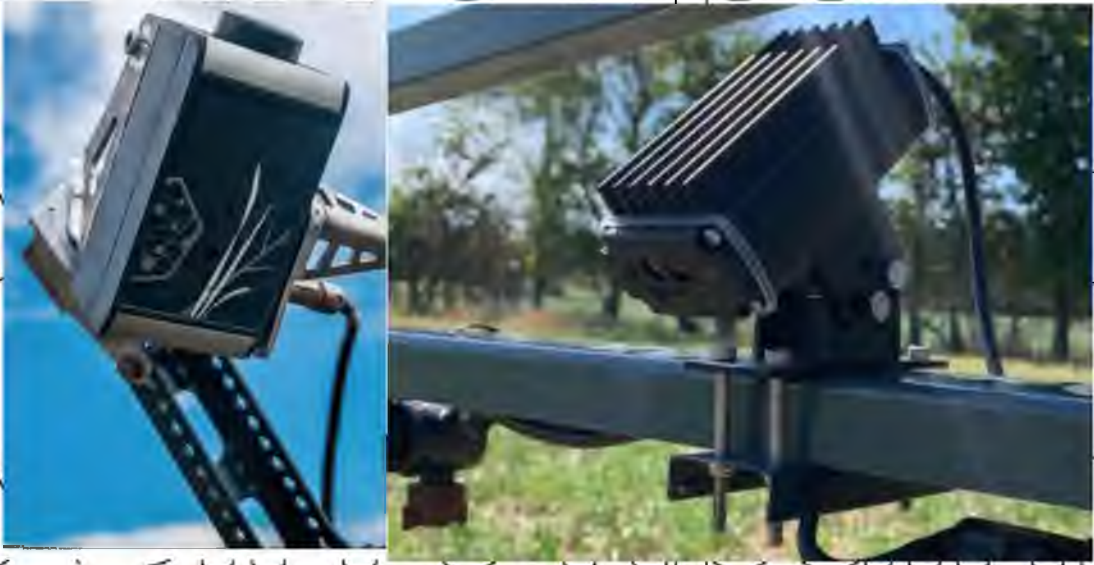
Рисунок 29 - Сенсор камери системи ультралокалізованого обприскування
