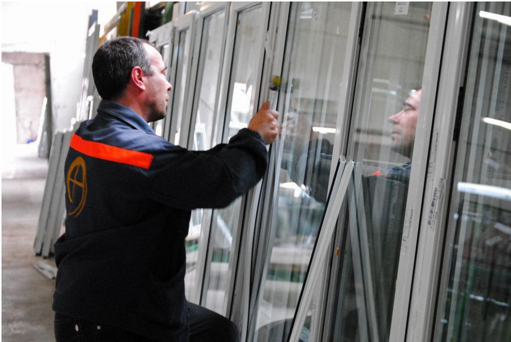
Рис.2.6. Перевірка на герметичність склопакета
