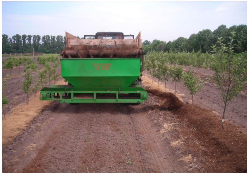
Рис. 7. Макетний зразок машини для внесення сипкого субстрату в пристовбурні смуги саду у процесі проведення виробничих випробувань
