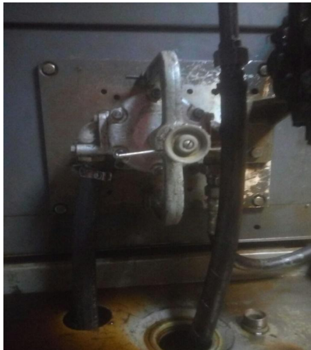
Рисунок 3.2 – Експериментальний насос НШ-32-К встановлений на стенді КИ-4815М для проведення експериментальних досліджень
