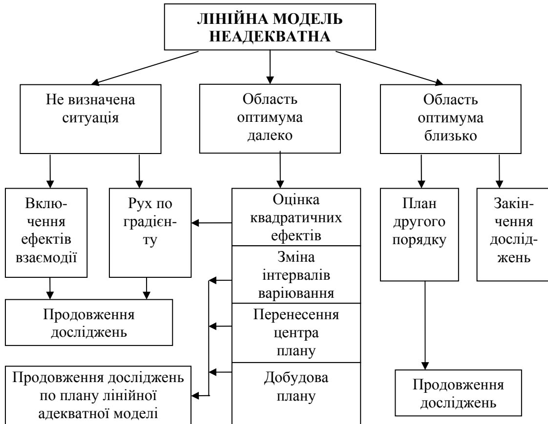
Рис. 9.2. Варіанти прийняття рішень в задачі визначення оптимальних умов при лінійній неадекватній моделі регресії
