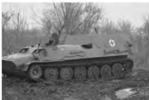
Рис. 2. Розташування люків десантного відділення у багатоцільовому медичному тягачі легкого бронювання МТЛБ евакуації поранених та хворих.
