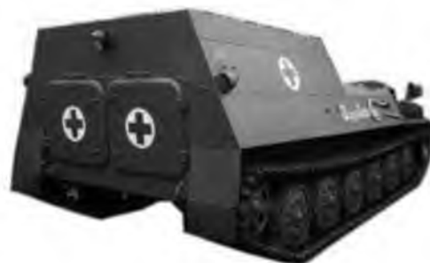
Рис. 2. Розташування люків десантного відділення у багатоцільовому медичному тягачі легкого бронювання МТЛБ евакуації поранених та хворих.
