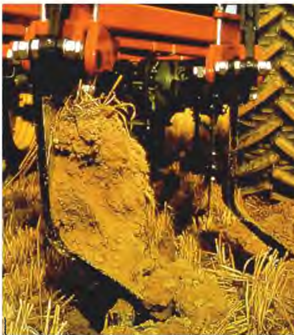
Рис. 1.4. Робота похилих стовб плуга-розпушувача «Fagorlow»
