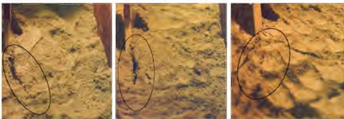
Рис. 4.5. Площини відколу при русі стовб з різним кутом заточення: а) кут заточування 10^\circ ; б) кут заточування 20^\circ ; в) кут заточування 30^\circ .
