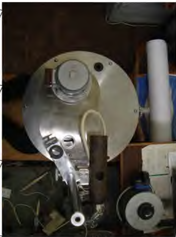
Рис 3.4. Загальний вигляд калориметра (вид зверху)
