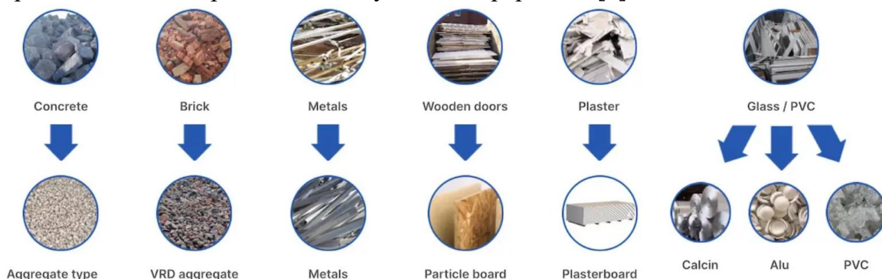
Рисунок 1 – Схема переробки будівельного сміття на нові матеріали [3].
