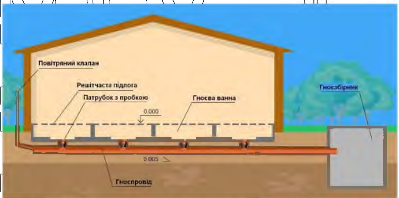
Рис. 2.3. Схема системи гноєвидалення
