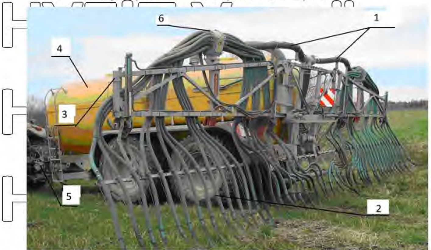
Рис. 3.3 - Схема агрегату для поверхневого стрічкового внесення через штангову систему з навісними шлангами ZUNHAMMER SZ 18.5 PUL
