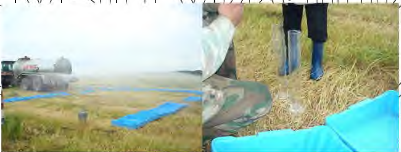
Рис. 4.1 - Визначення нерівномірності внесення при поверхневому внесенні розбризуванням.
