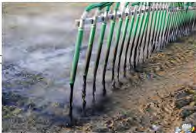
Рис. 1.7 - поверхнє внесення рідкого органічного добрива через розподільник із системою навісних плантів.
