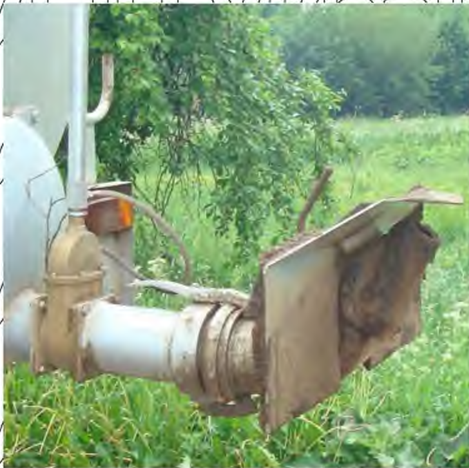
Рис. 3.2 – Схема робочого органу для поверхневого внесення.
