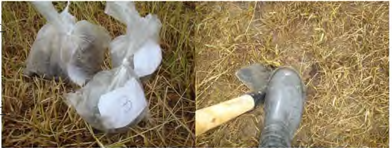
Рис. 4.2 - Відбір проб ґрунту після поверхневого внесення розбризкуванням.
