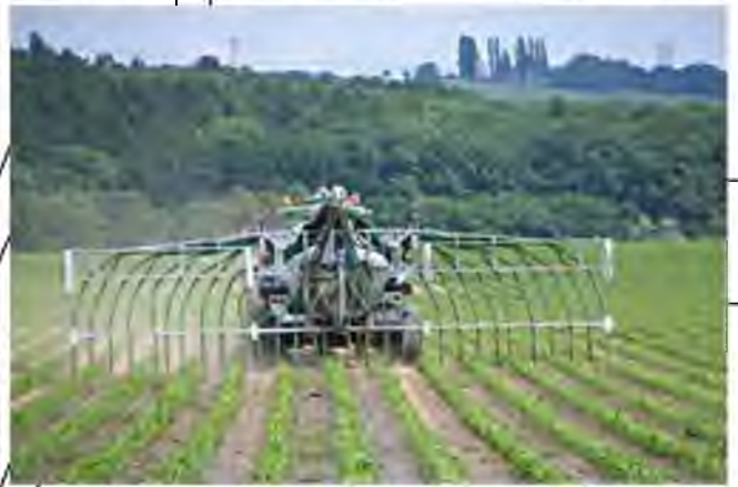
Рис. 1.7 - поверхнє внесення рідкого органічного добрива через розподільник із системою навісних плантів.
