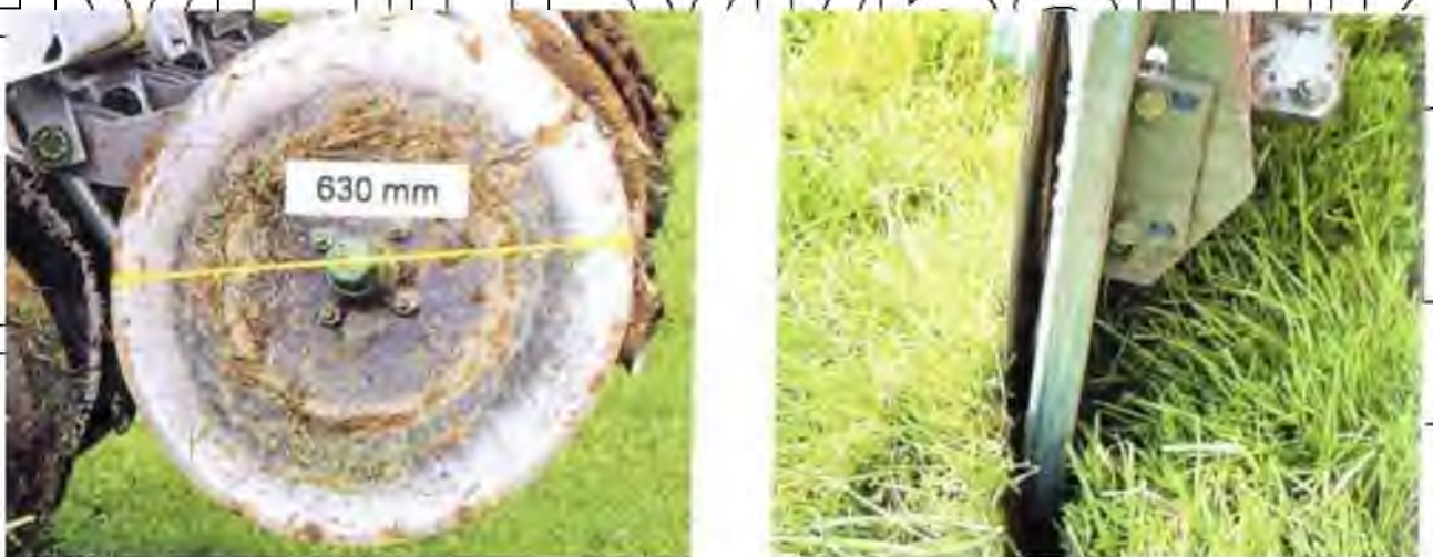
Рис. 1.9 - Внутрішньоґрунтове внесення під тиском рідкого органічного добрива у відкриті борозенки.
