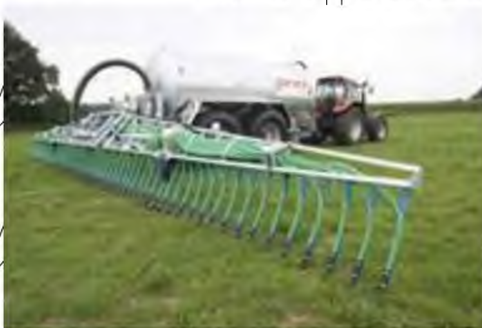
Рис. 1.3 - Поверхнєве внесення рідкого органічного добрива через розподільник із башмаковою системою навісних шлангів.
