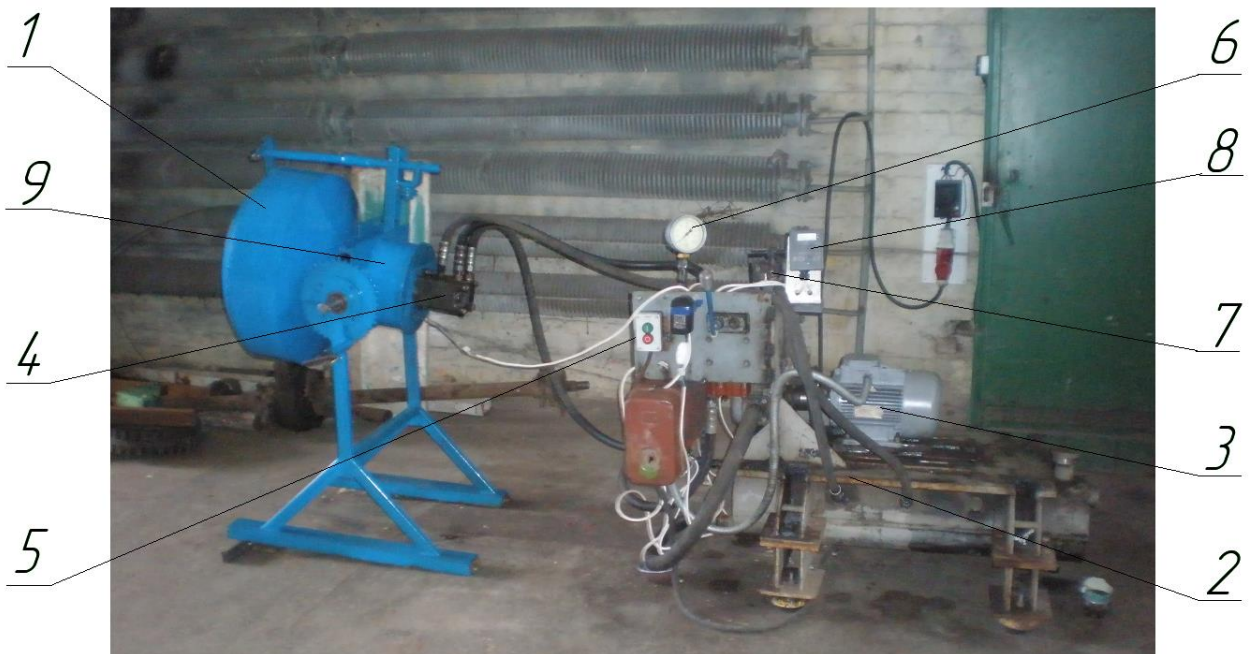
Рис. 6. Загальний вигляд експериментальної установки: 1 – дражиратор; 2 – гідростанція; 3 – електродвигун; 4 – гідромотор; 5 – блок керування; 6 – манометр; 7 – регульований дросель; 8 – пристрій контролю частоти обертання; 9 – коробчастий блок
